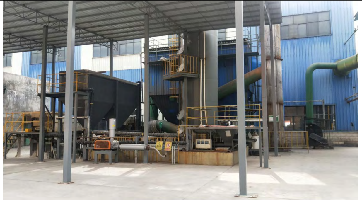
布袋除尘器+次氯酸钙吸收脱硝设施
