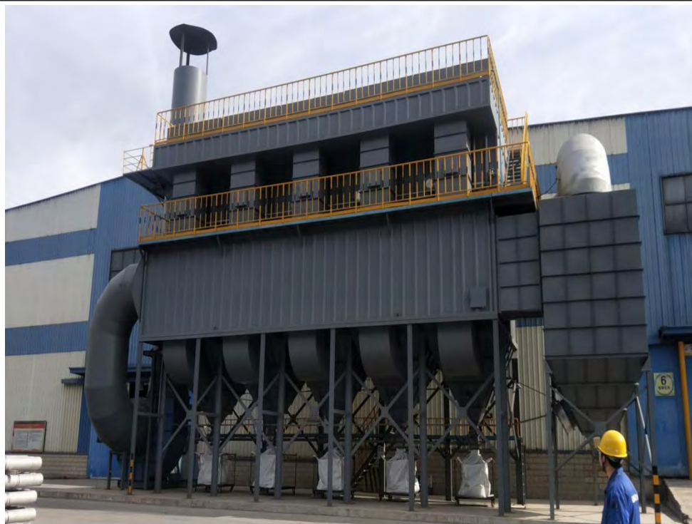
熔铝炉集气罩废气布袋除尘器
